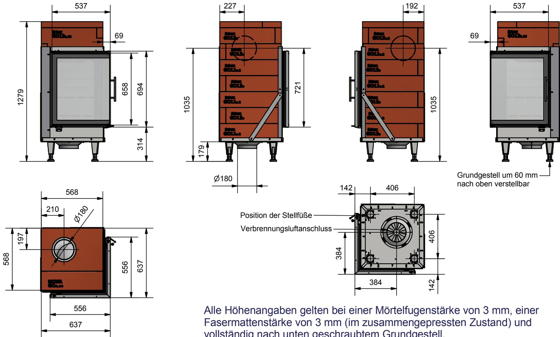
Alle Höhenangaben gelten bei einer Mörtelfugenstärke von 3 mm, einer Fasermattenstärke von 3 mm (im zusammengedrückten Zustand) und vollständig nach unten geschraubtem Grundgestell.
